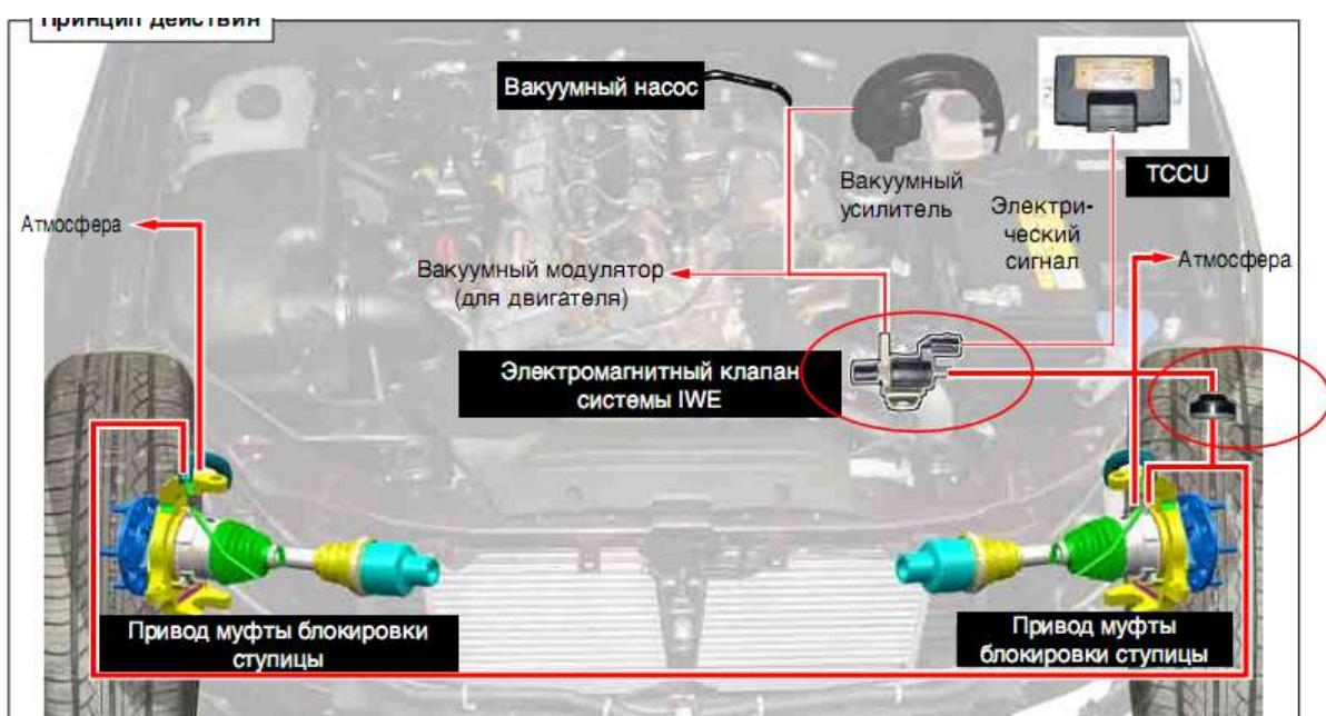
**Функционирование вакуумной системы в заднеприводном режиме**
