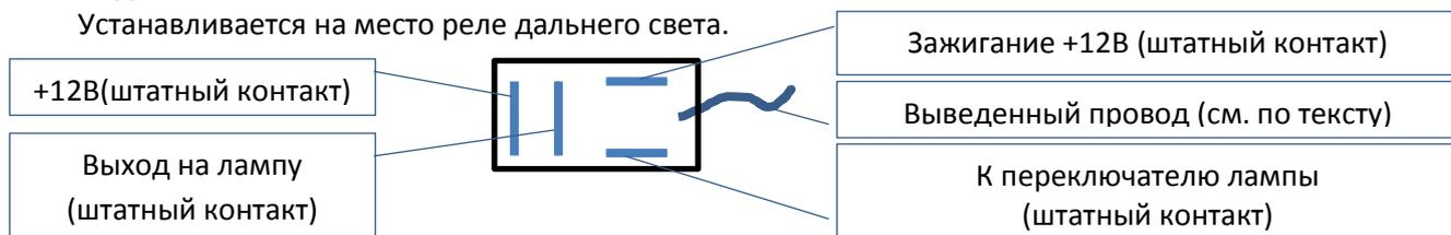
Отдельно выведенный провод должен быть подключен к лампе габаритных огней или ближнего света. Проще всего подключить к соответствующему предохранителю. Если провод не подключен, то считается что на нем +12В и устройство работает как обычное реле, провод в этом случае необходимо изолировать.
