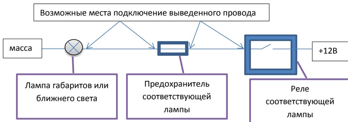
**ПРИ УСТАНОВКЕ СЛЕДУЕТ СЛЕДИТЬ ЗА СОСТОЯНИЕМ ИЗОЛЯЦИИ ВЫВЕДЕННОГО ПРОВОДА ЛЮБОГО РОДА ПОВРЕЖДЕНИЯ (ЗАМЯТИЯ, ПОРЕЗЫ И Т.Д.) ДОЛЖНЫ БЫТЬ УСТРАНЕНЫ, А МЕСТО ПОДКЛЮЧЕНИЯ ПРОВЕРЕНО НА ОТСУТСТВИЕ ЗАМЫКАНИЯ С ДРУГОЙ ЦЕПЬЮ.**
