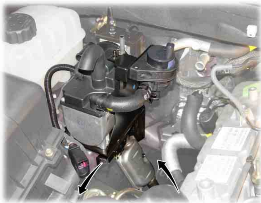
Крепление со стороны трубы выпуска отработавших газов автономного подогревателя
